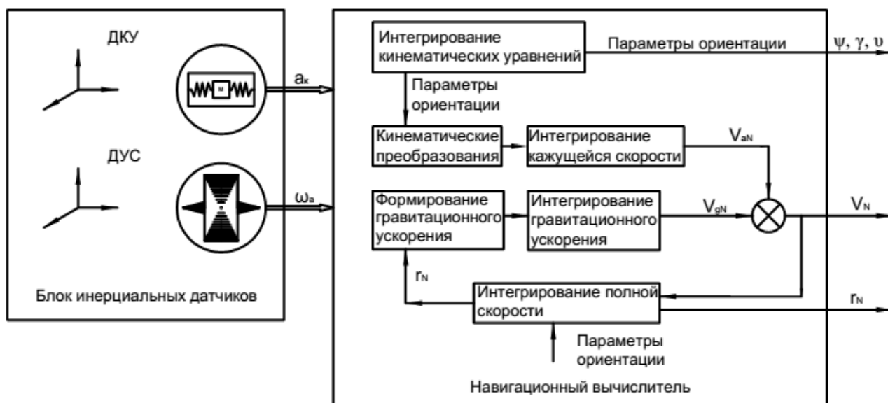
Рисунок 1 – Упрощенная блок-схема безлатформенной инерциальной навигационной системы:
