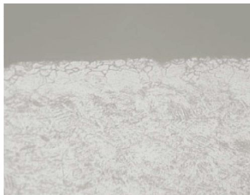
Рисунок 2 – Микроструктура азотированного слоя стали 12Х18Н9Т
