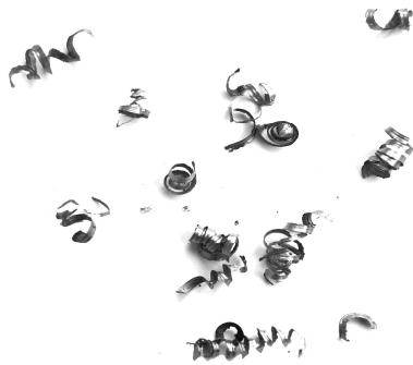
Рисунок 4 – Фотографія фрагментів подрібненої стружки
