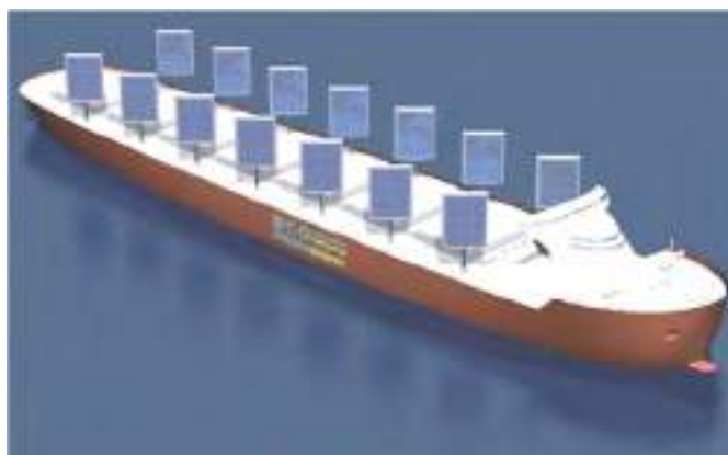
Рисунок 3 – Система поворотных мачтовых парусов в проекте судна 2025 года eco marinepower , объединенных с солнечными батареями (Япония)
