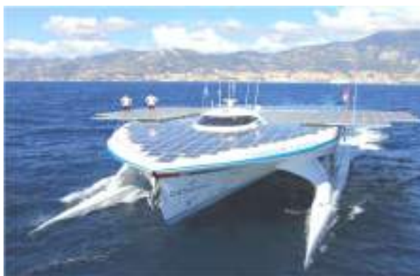
Рисунок 9 – Катамаран « Turanor Solar Planet », работающий на солнечных батареях (Германия)
