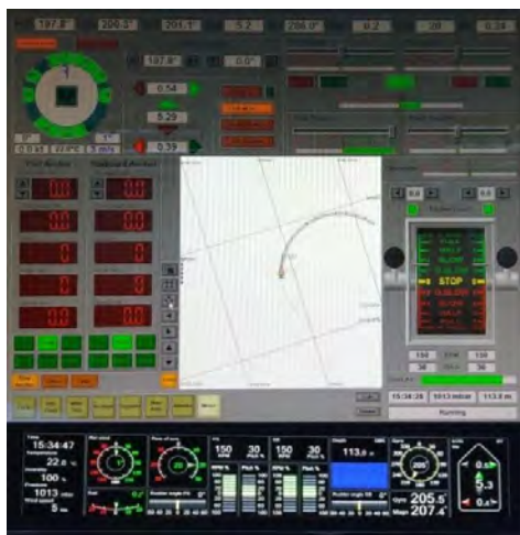
Рисунок 20 – Модель OSV 3 АН. Положення ПП в задній частині судна на ходові вперед під час обертання судна праворуч
