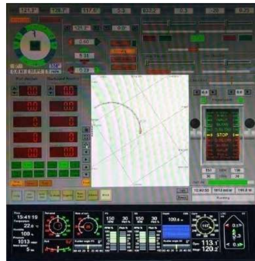
Рисунок 21 – Модель OSV 3 АН. Положення ПП в задній частині судна на ходові вперед під час обертання судна ліворуч
