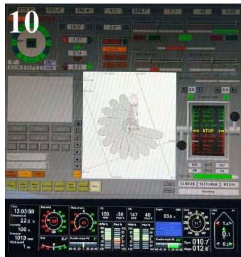
Рисунок 7 – Положення ПП у кормовій частині судна під час обертання ліворуч
