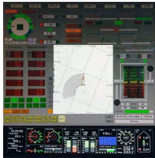
Рисунок 11 – Положення ПП позаду корми судна під час обертання ліворуч
