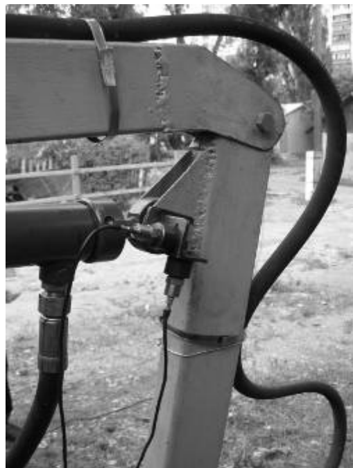
Рисунок 3 – Схема розміщення датчиків на фізичній моделі крана-маніпулятора (а) та місця встановлення датчиків тиску (б) і датчиків прискорення (в)
